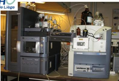
**Appareil :** Système UPLC Acquity® Waters couplé à un spectromètre de masse tandem Quattro Premier Waters
