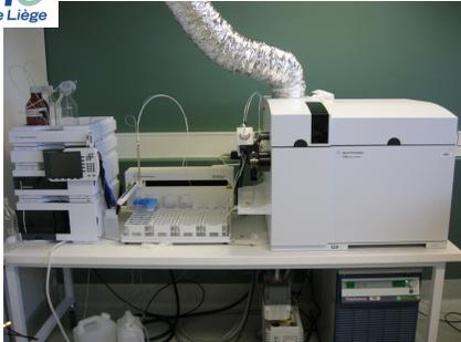
**Appareil : ICP/MS 7700x Agilent**
